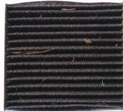
劣化したフィルター
